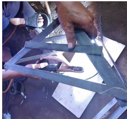
Gambar 11. Penambahan bagian plat penguat pada perkakas
