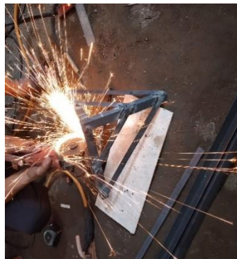
Gambar 12. Penghalusan permukaan hasil lasan pada Perkakas
