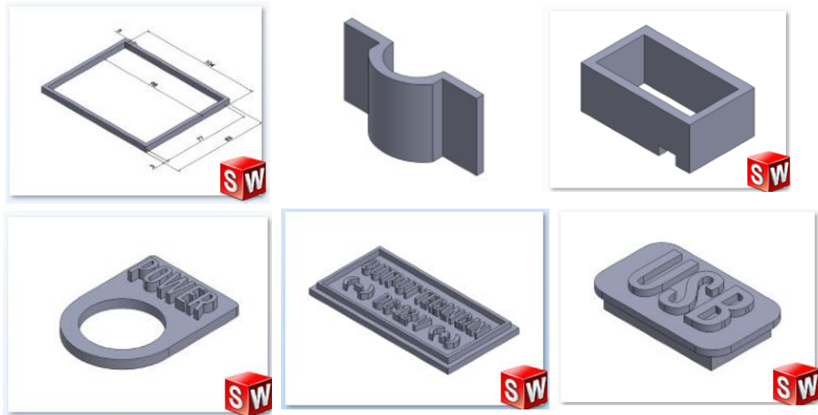
Gambar 1. Desain CAD perangkat pendukung sistem kontroler berbasis IoT
